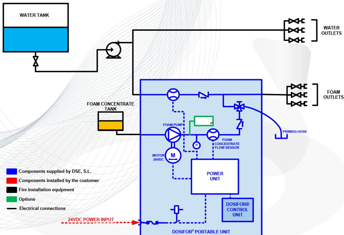
El **DOSIFOR™ - 20NP/P** mide los caudales de agua y de espumógeno modificando la velocidad de la bomba de espumógeno para mantener la proporción especificada, independientemente de las fluctuaciones del caudal de agua y de la presión. Además del modo de control automático, el sistema dispone de un modo manual que permite el ajuste manual de la velocidad de la bomba (para el cebado, la limpieza, la calibración...).
