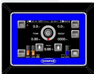
La unidad de control del **DOSIFOR™ - 5NPI** está formada por una pantalla táctil de 7" en color de alta luminosidad y legible a la luz del sol, fácil de usar y llena de información útil para el usuario. Esta unidad muestra el caudal real de agua y de espumógeno, así como los totalizadores e información de funcionamiento de la bomba de espumógeno.
